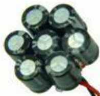
Goldcap-Module mit 7 Goldcaps (7 x 1F in Serie, also 140000 F - 17,5 V)
