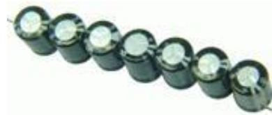
Goldcap-Module mit 7 Goldcaps (7 x 1F in Serie, also 140000 F - 17,5 V)
